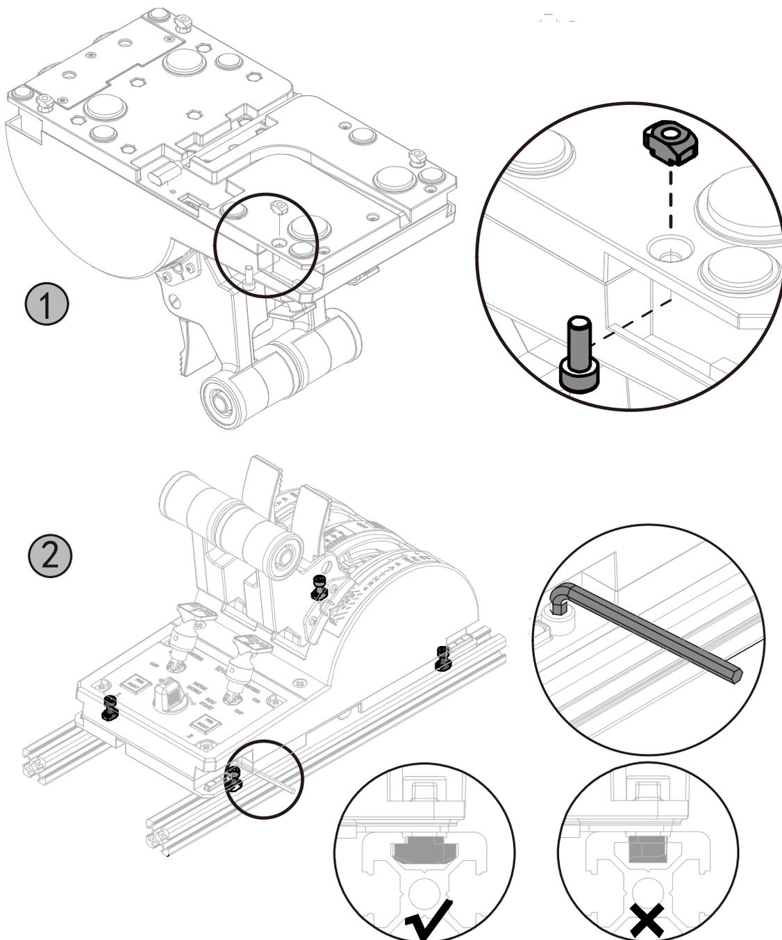
翻转产品将 M4\*12 螺钉斜向穿入孔, 拧入 M4 螺母 (拧入 2-3 圈即可);
