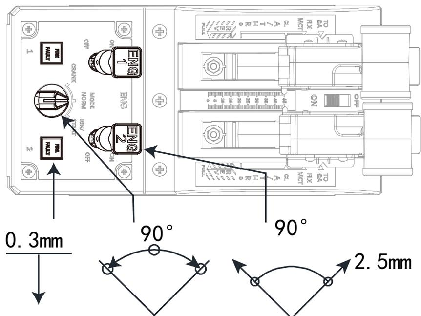
1.2.1 扳机行程  $78^\circ$  ; \*注意: 扳机为塑料制品在猛烈冲击及大载荷情况下易发生断裂 (操作力是不可大于 40N)
